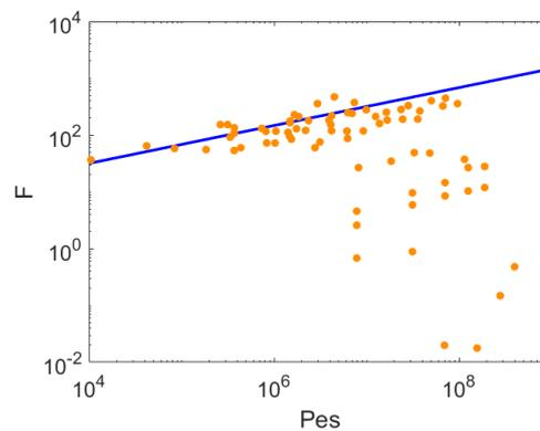
FIGURE 3 – Taux de capture adimensionné  $F = J/(c_0 W_s D)$  en fonction du nombre de Peclet  $P_{e_s}$  à proximité du capteur. Les ronds représentent les points expérimentaux obtenus avec des particules et la droite représente la théorie obtenue avec des molécules. Une partie des points s’alignent sur la droite de la théorie pré-existante tandis que le reste semble indiquer un taux de capture plus faible que ce que prévoit la théorie moléculaire.
